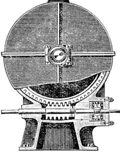
Komplete Schneckengetriebe mit höchstem Nutzeffekt.
