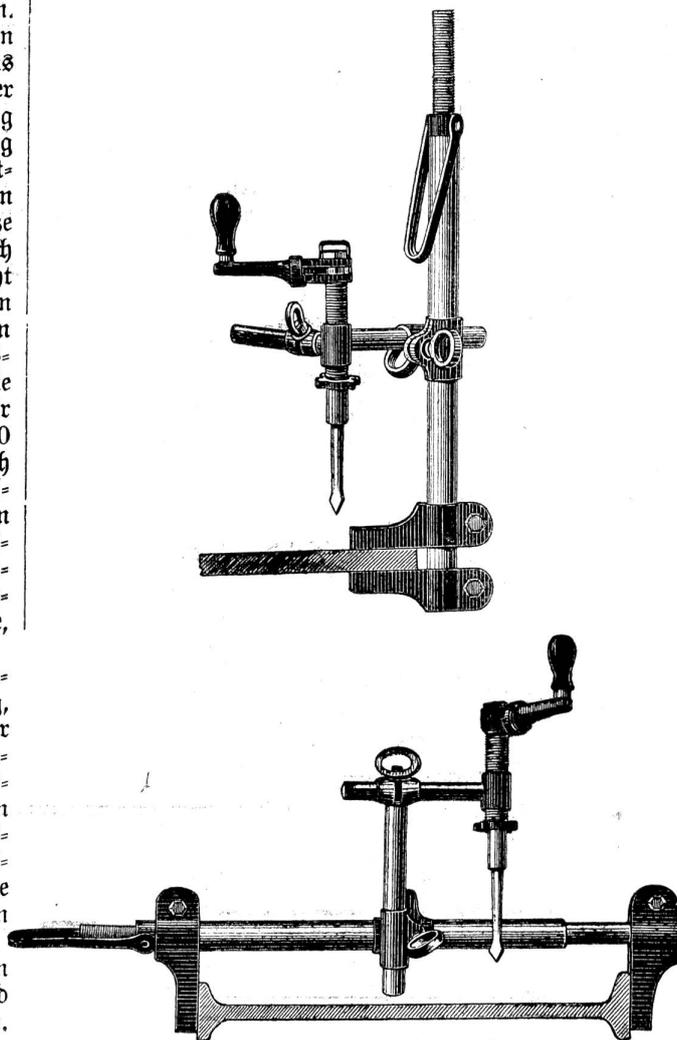
treiben an der Kurbel, so daß der Bohrer aus dem Loch geht. — Die Bohrspindel ist hohl, und kann der Bohrer mit einem Stift ausgeschlagen werden.
