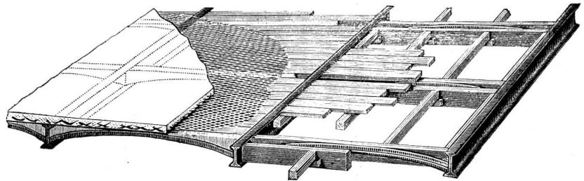
Fig. 11. Goldings Deckenkonstruktion.
