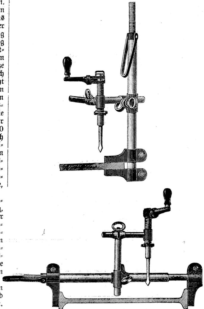
treiben an der Kurbel, so daß der Bohrer aus dem Loch geht. — Die Bohrspindel ist hohl, und kann der Bohrer mit einem Stift ausgeschlagen werden.
