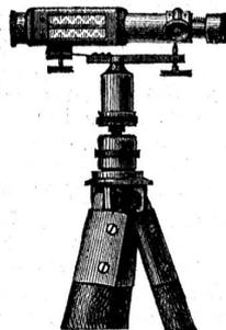
Seitwärts in der Wandung des Fernrohrs ist eine Reversionälibelle parallel zur optischen Ase befestigt, derselben gegenüber der Spiegel. Von dem mit zwei nebeneinander gefaßten Linsen versehenen Ocular ist die mittlere die Vergrößerung gebende, die seitliche Linse (Lupenlinse) dient zur Sichtbarmachung des im Spiegel
