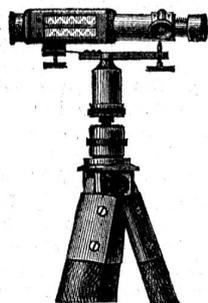
Seitwärts in der Wandung des Fernrohres ist eine Reversionälibelle parallel zur optischen Ase befestigt, derselben gegenüber der Spiegel. Von dem mit zwei nebeneinander gefaßten Linsen versehenen Ocular ist die mittlere die Vergrößerung gebende, die seitliche Linse (Lupenlinse) dient zur Sichtbarmachung des im Spiegel
