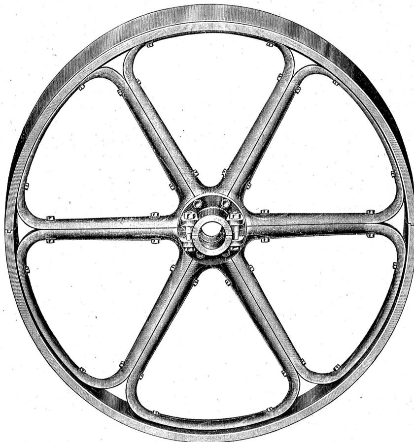
Die einzelnen Teile sind nicht geleimt und werden unter sich mit Metallschrauben verschraubt, so daß kein Reißen und kein Verziehen möglich ist. Es sind nur gleichlaufende Fasern verbunden und der Kranz wird am ganzen Umfange gestützt.
