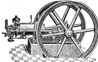
Stehende und liegende Anordnung, bis 50 Pferdekraft und mehr. Einfache Konstruktion, solider Bau, geräuschloser Gang, höchste Leistungsfähigkeit, minimaler Gasverbrauch; für alle gewerblichen Zwecke, insbesondere auch für elektrisches Licht. Weltgeheudste Garantien. 2667 b
