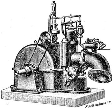
für Hochdruck, mit patentierten Löffelrädern, mit oder ohne automatischem Regulator.
