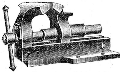
mit verbesserten, verdeckten Geläufen und Stahlmälern; letztere nachschärfbar. Keine eingeschraubten Backen.
