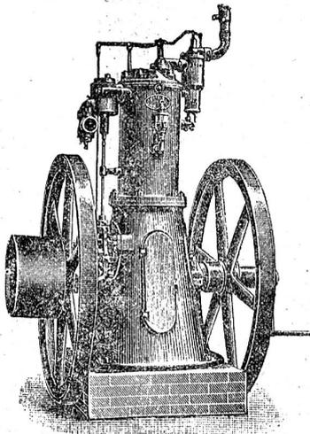
Unbedingt zuverlässiger und ruhiger Gang. Betrieb mit gewöhnlichem Lampenpetroleum oder Benzin. Grösste Dauerhaftigkeit, einfachste Konstruktion. Konsum der Benzin- und Petroleum-Motoren cirka 0,4 bis 0,6 Liter gewöhnliches, billiges Lampenpetroleum oder Benzin pro Pferdekraft und Stunde.
