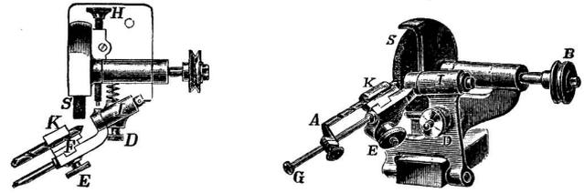
Durch Herstellung obiger Maschine wurde einem großen Uebelstande abgeholfen, der bis jetzt an den bestehenden Spiralbohrerschleifmaschinen existierte, da mit diesen stets nur Bohrer von 6 mm und dicker geschliffen werden konnten.
