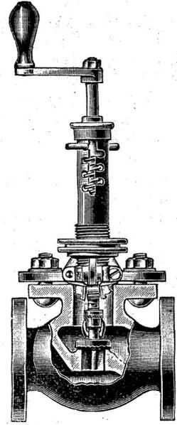
Fig. 4. Aufschleifen des Ventiltiegels auf den Ventilsitz.
