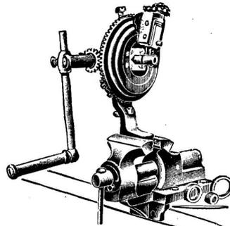
Es ist dann noch die Einrichtung getroffen, daß die Zustellung des Abstechmessers selbsttätig erfolgt, so daß der betreffende Arbeiter nur an der Handkurbel zu drehen hat, bis das Rohr durchgeschnitten ist. Das Abstechmesser muß dabei natürlich geschmiert werden, am besten mit rohem Leinöl.
