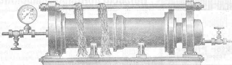
Muffe eines Rohres 300 mm Lichtweite, abgedichtet mit Bühne's Bleiwolle und auf 20 Atm. gepresst.
