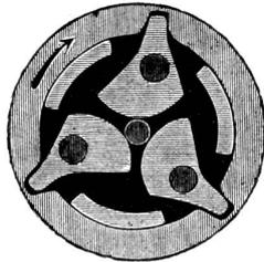
desto fester spannen die exzentrisch angeordneten Spannbacken. Hält man während des Ganges der Maschine das Bohrfutter etwas fest, so werden die Backen lose, der Bohrer kann herausgenommen und durch einen anderen ersetzt werden, was bei den gewöhnlichen Bohrfuttern bisher nur mit großem Zeitverlust möglich war. Vollste
