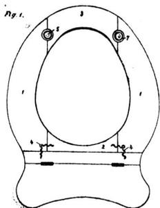
Figur 1 zeigt ein Klosettsitzbrett in Unteransicht. Der Sitz besteht hinten aus einer gefederten Anfassungsleiste, welche verhindert, daß die Feuchtigkeit durchdringt und daher ein Reißen oder Plagen des Sitzes vollständig ausgeschlossen ist.
