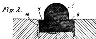
Figur 2 ist ein Vertikalschnitt durch einen im Klosettsitzbrett befestigten Puffer.
