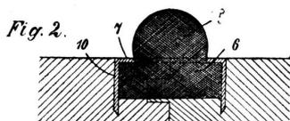
Figur 2 ist ein Vertikalschnitt durch einen im Klosettsitzbrett befestigten Puffer.
