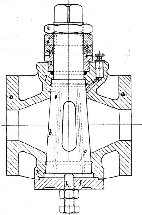
Schraube h stets  $\frac{1}{2}$  Gang gelöst sein, man drehe dieselbe jedoch nicht häufiger als nötig heraus, damit diese nicht verstellt wird. Undichtigkeiten sind also fast gänzlich ausgeschlossen, da der Konus des Rückens nach oben gelagert ist und so der Hahn bei richtiger Einstellung sich selbst abdichtet. Durch die erwähnte Anordnung des Rückens ist ferner ein Herausfliegen des letzteren während des Abschlämmens ausgeschlossen, so daß Unglücksfälle durch Verbrühen nicht vorkommen können.
