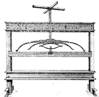
Die 36 mm starke Spindel wird durch einen Schlüssel in Kreuzform aus Eisenrohr gedreht. Die lichte Entfernung zwischen den Seitenstreben beträgt 101 cm, die lichte Höhe bis zur Druckplatte 28 cm.
