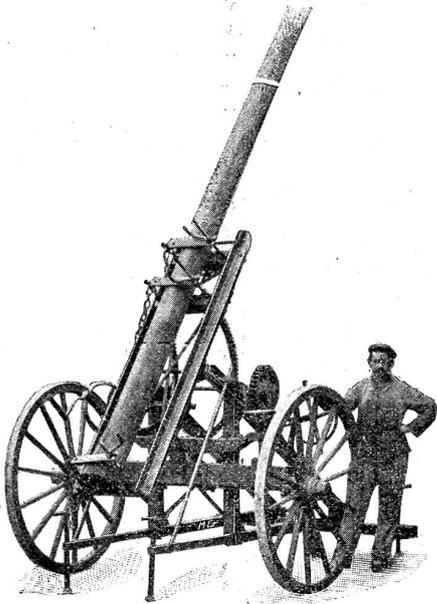
man wirklich staunen muß, was unsere Techniker alles herausdüsteln, damit Arbeit und Zeit gespart wird. Der zweirädrige, leicht zu stoßende Wagen wird an die Gerüststange nahe gebracht; zwei Klammern werden angebracht, ein Mann beginnt die Kurbel zu drehen und in
