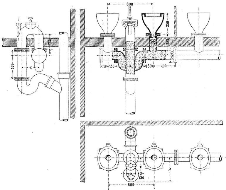
in der Mitte des Sammelrohres zwischen zwei Trichter eingebaut werden. In den schematischen Darstellungen sind verschiedene Anordnungen des Absaugesiphons klar gelegt.
