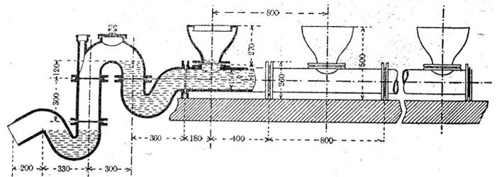
anerkennen, daß Flanschenrohre viel leichter, schneller und billiger montiert werden können. Die Kosten für Verdichtungsmaterial bleiben dem Installateur erspart, weil alle Schrauben und Verdichtungsringe mitgeliefert werden.
