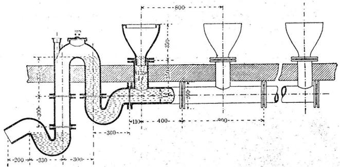
Daß außerdem die Muffenrohrabzweige schwierig zu montieren sind und die Verdichtung mit Blei und das Verstemmen dieser Muffendichtungen nur mit großem Aufwand an Zeit und Geld zu Lasten des Ausführenden geschieht, wird jeder Fachmann bestätigen und damit auch
