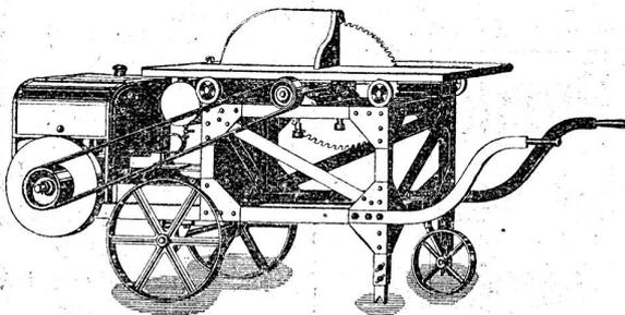
Fahrbare Kreissägen mit Benzinmotoren
