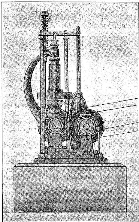
Eine der ersten Anwendungen dieses Regulators besteht in Olivone (Tessin) und zwar für eine Francis-turbine mit horizontaler Achse, welche nebst einer Gattersäge, einer Zirkularsäge und mehreren anderen Holzbearbeitungs-Maschinen eine Dynamo-Maschine, welche ruhiges Licht abgibt, antreibt.
