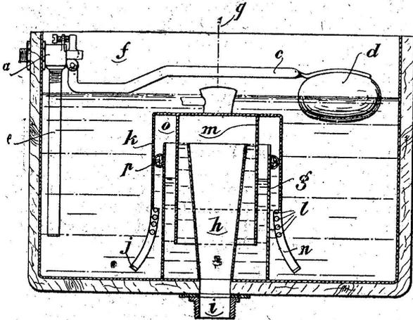
ring. Der Closet-Spül-Kasten kann in jeder beliebigen Höhe, auch direkt hinter dem Closet angebracht werden. Ein Ueberlaufen des Wassers im Kasten ist vollständig ausgeschlossen, da die im Raume o komprimierte Luft solches absaugt, sobald der Wasserspiegel über den Schwimmer hinausgeht.
