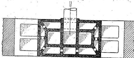
Die wenigen Fugen des Schofer-Kamins sind ein außerordentlicher Vorzug und sichern diesem eine weit über gemauerten Kaminen stehende Stellung, denn bei  $2,1 \text{ m}$  Höhe hat das Schofer-Kamin nur zwei nicht nach innen oder außen durchgehende Fugen, während ein gemauertes Kamin gleicher Größe  $27$  Lager- und  $168$  Stoßfugen hat.
