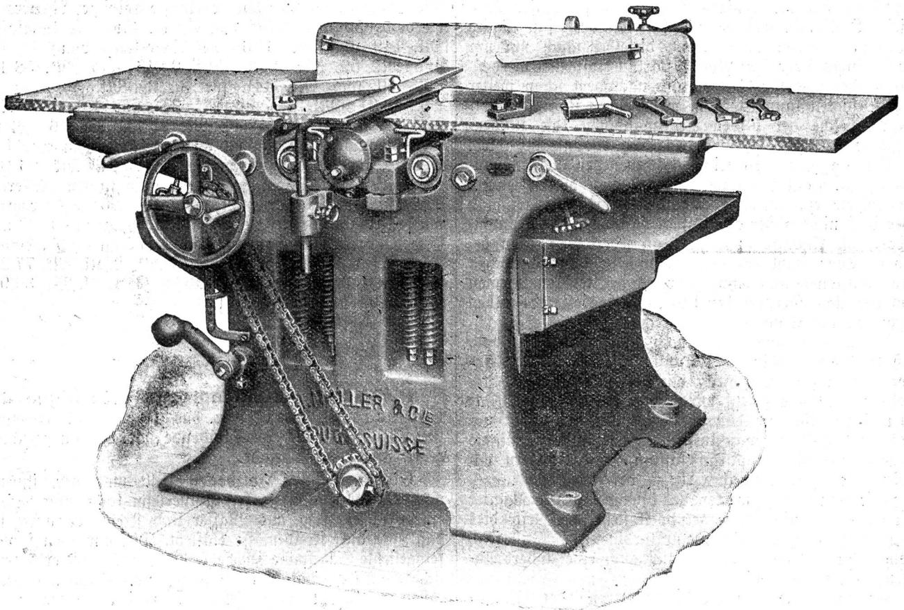
**Kombinierte Abricht- und Dickenhobelmaschine mit Kugellagerung; beide Abrichtetische, aus extra starken Flussplatten bestehend, einzeln in der Höhe stellbar mit patentierten
