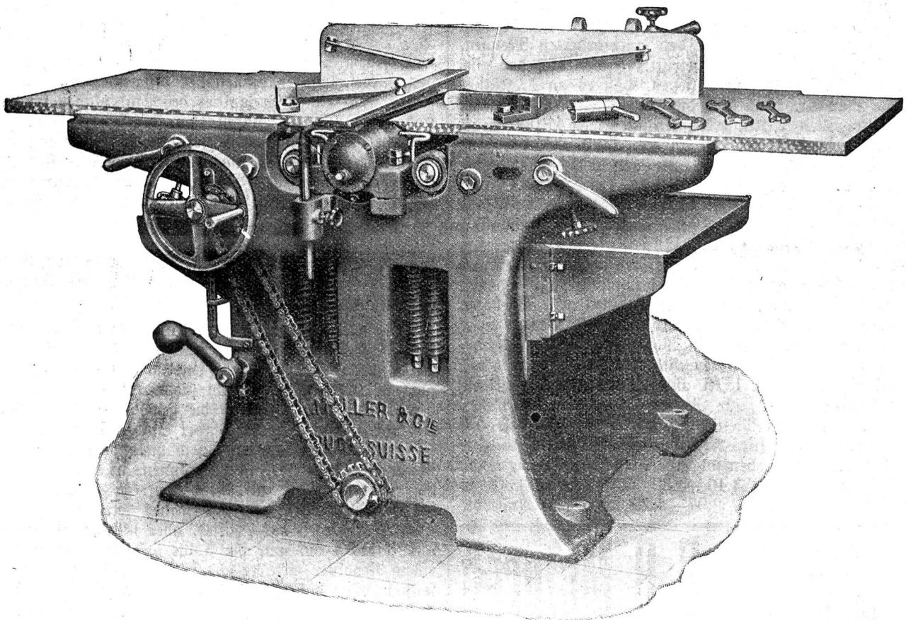
**Kombinierte Abricht- und Dickenhobelmaschine mit Kugellagerung; beide Abrichtetische, aus extra starken Flussplatten bestehend, einzeln in der Höhe stellbar mit patentierten .: federnden Tischwalzen, in Hobelbreiten von 360, 450, 530 und 600 mm. .:**
