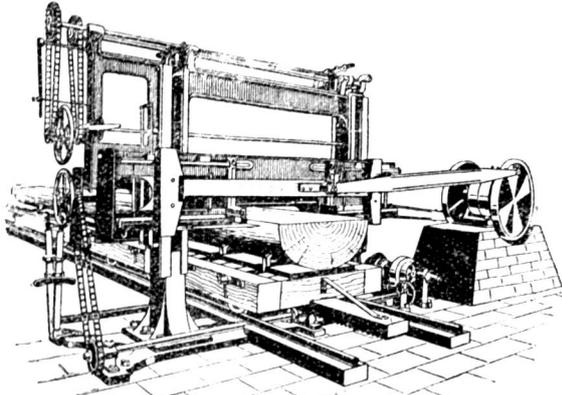
rahmen besonders zur Geltung. Dabei braucht das Doppelgatter nur den Platz eines einfachen Man kann die Produktionsfähigkeit der Maschine dadurch noch weiter steigern, daß man Doppellängeln in einen oder beide Sägerahmen einspannt; das Gatter kommt dann in der Leistung schon einem Vollgatter sehr nahe.
