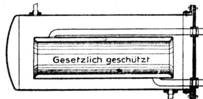
Für indirekte Heisswasserbereitung autogen geschweisst. Dieser Flüssigkeitserhitzer besteht aus einem Doppelzylinder aus stark. Eisenblech mit Zu- und Rücklaufleitungen. Derselbe kann wie
