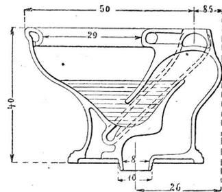
Das Absauge-Klosetts ist ein Niederspül-Klosetts, dessen Spülung durch eine besondere Konstruktion unterstützt wird, die dadurch den Syphon zum Leerlaufen
