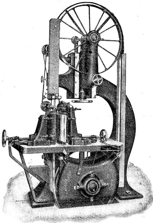
Trenn-Bandsäge mit selbsttätigem Walzenezug.
