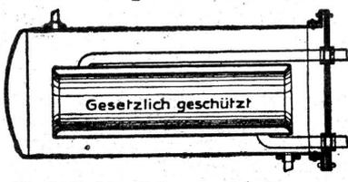
Für indirekte Heisswasserbereitung autogen geschweisst. Dieser Wassererhitzer besteht aus einem Doppelzylinder aus starkem Stahlblech mit Zu- und Rücklaufleitungen. Derselbe kann, wie obenstehende Abbildung zeigt, in jeden beliebigen Boiler eingesetzt werden. Nur durch dieses System ist das grösstmögliche Quantum Heisswasser für Bad- und Abwaschw Zwecke usw. zu erzielen. Beste und billigste Bezugsquelle. 2001
