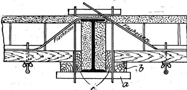
dann gleich zwei Fliegen mit einer Klappe, man hat erstens ein Auflager für die L-Träger und auch gleich eine Einschalung für die Ausbetonierung der Unterzüge.
