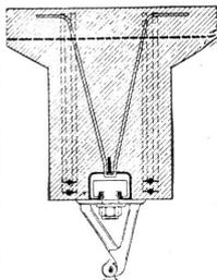
**Jeder Baumeister** sollte die **D. K. G. Ankerschienen** zur Befestigung von **Transmissionen**, Rohrleitungen und sonstigen Gegenständen in Betonbauten kennen, weil diese die einzigen rationellen u. modernen Befestigungsmittel sind. Sie gestatten ein nachträgliches Verschieben der Transmissionen nach Belieben und können als Armierungseisen ausgenutzt werden.
