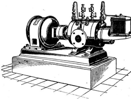
Direkte Kupplung mit Elektromotoren o. Riemenbetrieb.
