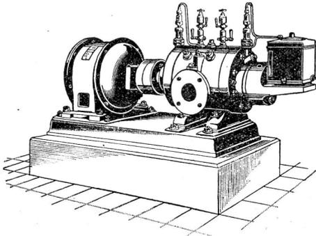
Direkte Kupplung mit Elektromotoren o. Riemenbetrieb.
