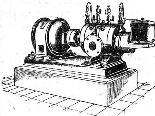
Direkte Kupplung mit Elektromotoren o. Riemenbetrieb.
