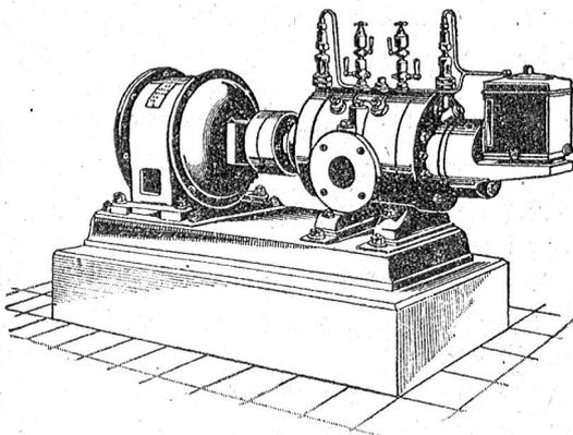
Direkte Kupplung mit Elektromotoren o. Riemenbetrieb.
