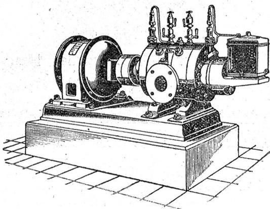
Direkte Kupplung mit Elektromotoren o. Riemenbetrieb.
