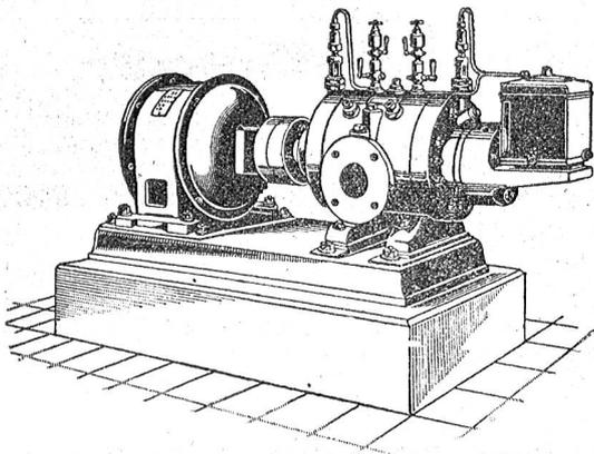
Direkte Kupplung mit Elektromotoren o. Riemenbetrieb.
