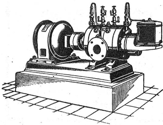
Direkte Kupplung mit Elektromotoren o. Riemenbetrieb.
