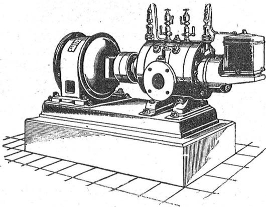
Direkte Kupplung mit Elektromotoren o. Riemenbetrieb.
