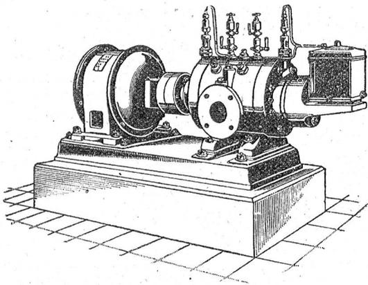
Direkte Kupplung mit Elektromotoren o. Riemenbetrieb.
