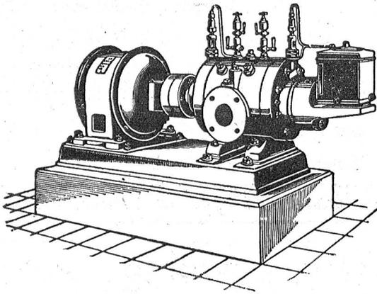
Direkte Kupplung mit Elektromotoren o. Riemenbetrieb.
