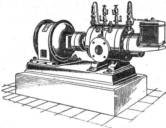
Direkte Kupplung mit Elektromotoren o. Riemenbetrieb.
