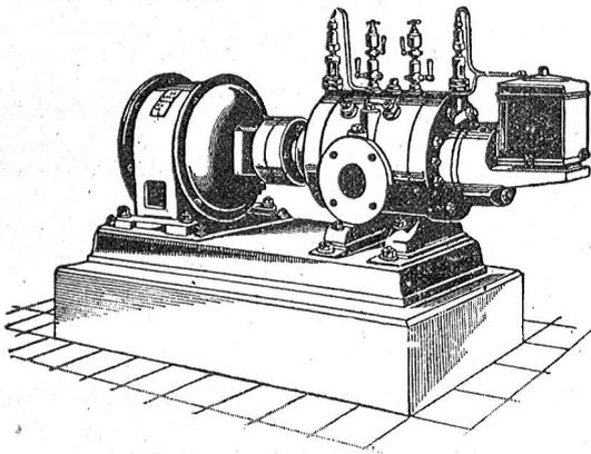
Direkte Kupplung mit Elektromotoren o. Riemenbetrieb.
