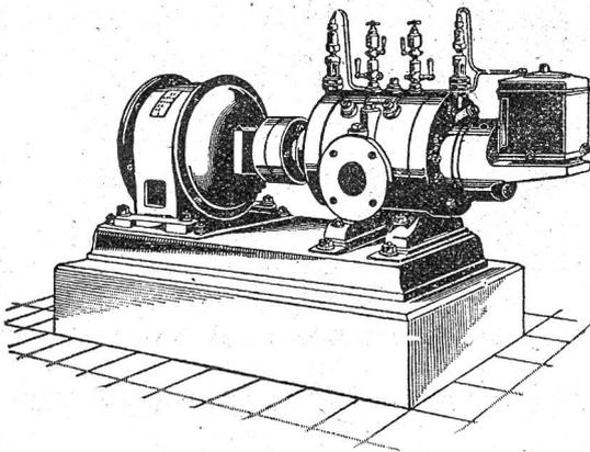
Direkte Kupplung mit Elektromotoren o. Riemenbetrieb.
