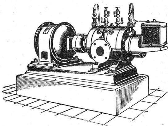
Direkte Kupplung mit Elektromotoren o. Riemenbetrieb.
