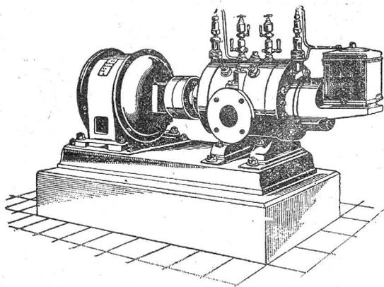
Direkte Kupplung mit Elektromotoren o. Riemenbetrieb.
